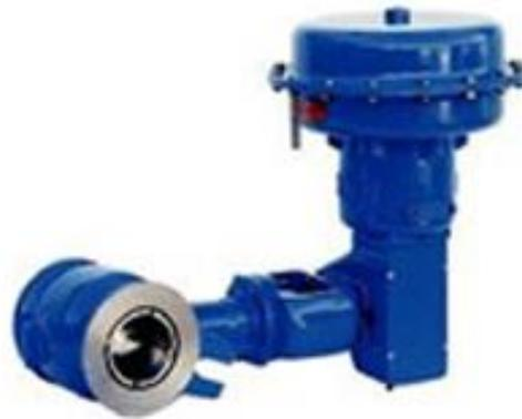
Válvula de control con movimiento giratorio del obturador excêntrico y función de auto alineación en el contacto del asiento, que proporciona una excelente estanqueidad con un bajo par de accionamiento. Esta válvula está diseñada para satisfacer presiones diferenciales de hasta 50 barg. Su obturador excêntrico le brinda una capacidad de alcance superior en comparación con otros tipos de obturador.
